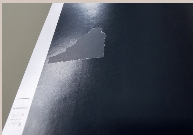
Abbildung 3: Tesatest auf unkaschiertem Bogen.
